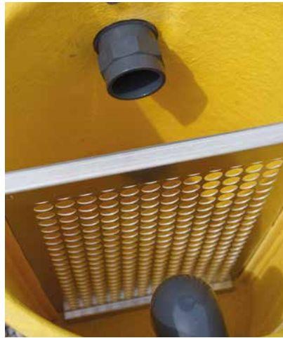
Filterung mit Edelstahl-Lochgitter
